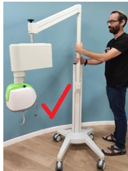
Figure 140 : Façon **CORRECTE** de déplacer le troisième support d'antenne
