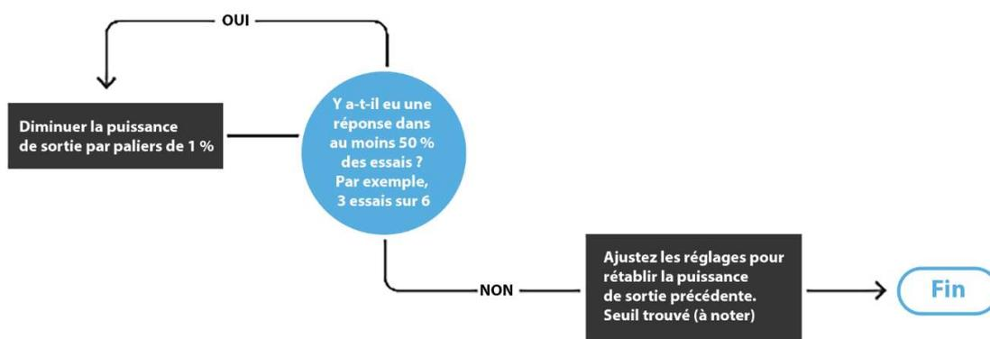
Figure 52 : Détermination du seuil d'intensité minimale
