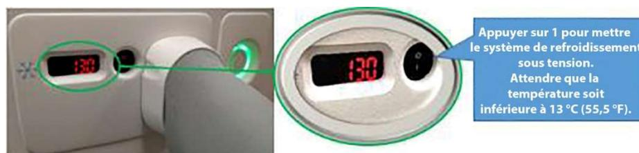
Figure 67 : Actionnez le système de refroidissement en appuyant sur **I** sur le bouton noir.
