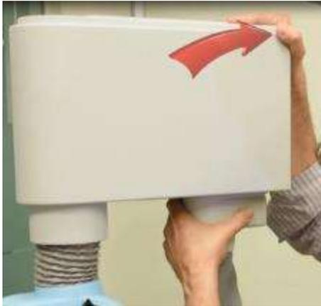
Figure 135 : Fixer l'ensemble du connecteur
