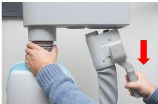
Figure 138 : Tirer l'ensemble du connecteur vers le bas
