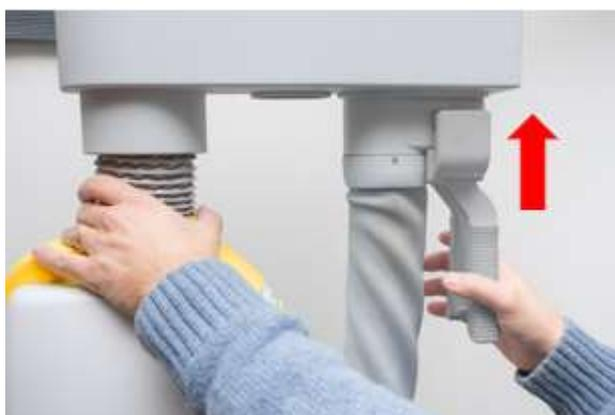
Figure 140 : Fixer l'ensemble du connecteur
